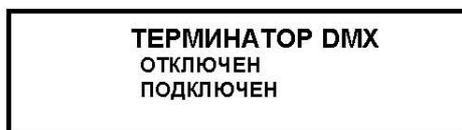
Выбор варианта “подключен/отключен” – с помощью вращения ручки энкодера. Подтверждение выбора – нажатие на ручку энкодера.
